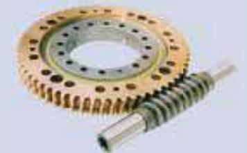
Jeu d'engrenages à vis sans fin sans cadre avec couronne d'orientation intégrée, version ainsi que de moments de renversement (fonctionnement à température élevée) pour un appareil rotatif de chariot élévateur (IMO fournit le jeu d'engrenages à vis sans fin, le client le monte dans son propre carter)
